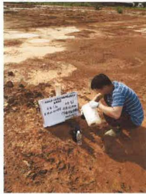
U4地下水采样
