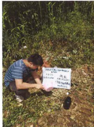
U5地下水采样
