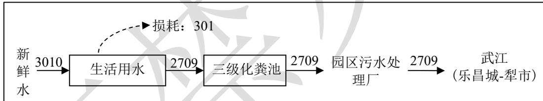
图 1 本项目水平衡示意图（单位 m<sup>3</sup>/a）
